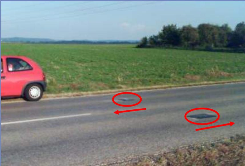
24h-Belastung mittels Plattendetektoren
