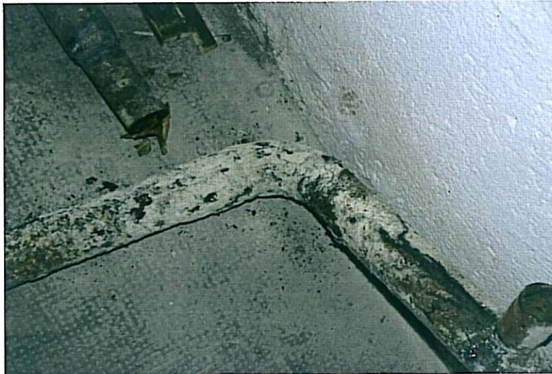
Bild 6: in 2010 ausgebautes Rohr mit starker äußerer Korrosion (Unter-Putz-Verlegung)
