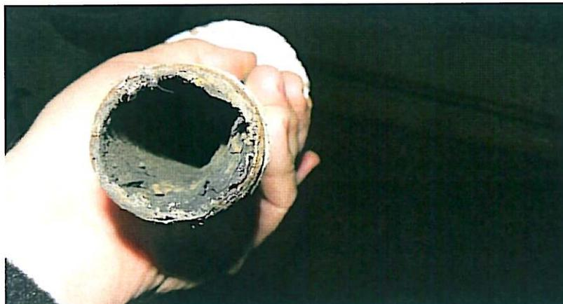
Bild 4: in 2010 ausgebautes Rohr mit starker Innenkorrosion und den daraus result. Ablagerungen
