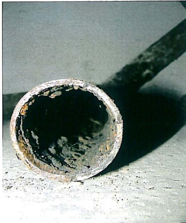
Bild 5: in 2010 ausgebautes Rohr mit starker Innenkorrosion und den daraus result. Ablagerungen
